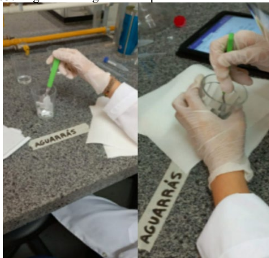
Figura 03: Registros da aguarrás no processo de mistura com isopor.
