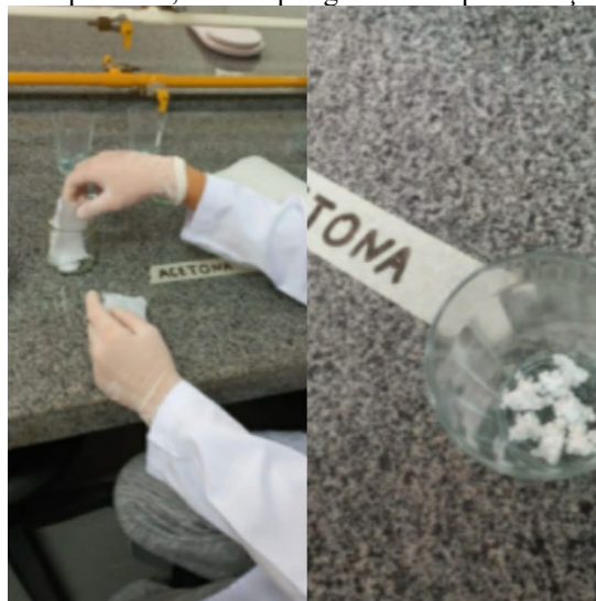
Figura 06: Registro do processo, e do isopor granulado após a reação com acetona pura.
