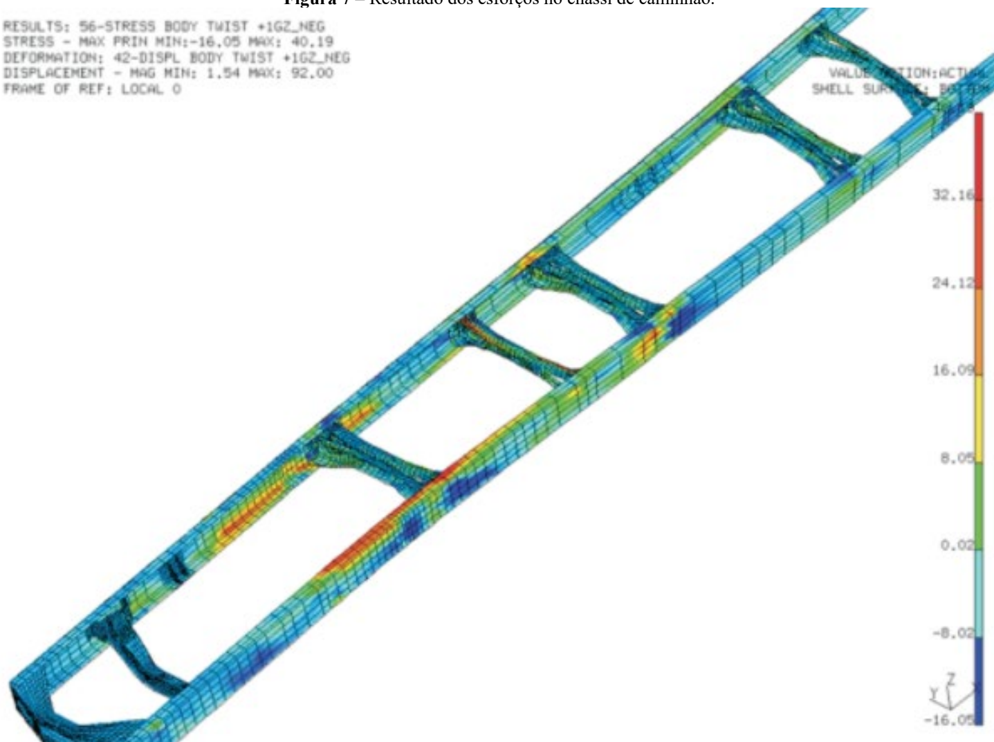
Figura 7 – Resultado dos esforços no chassi de caminhão.
