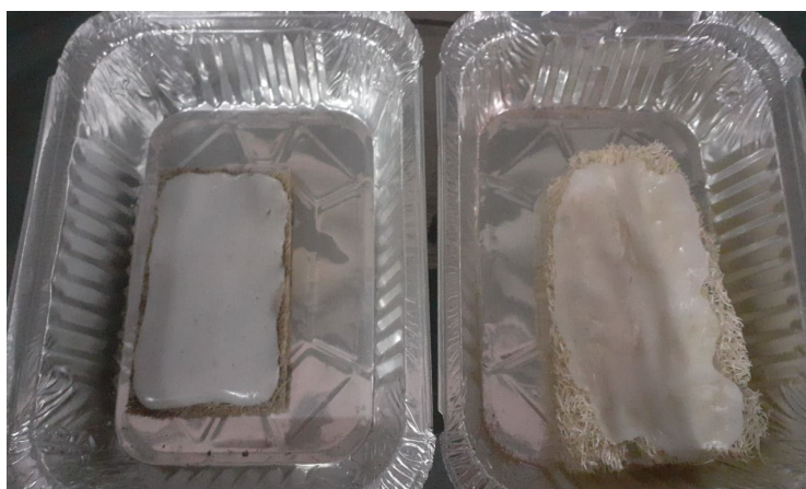
Figura 10: Amostras da acetona pura com a fibra de coco e fibra de bucha vegetal.
