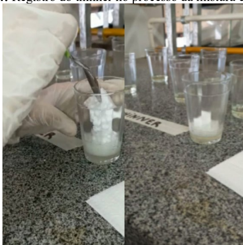
Figura 04: Registro do thinner no processo da mistura com isopor.
