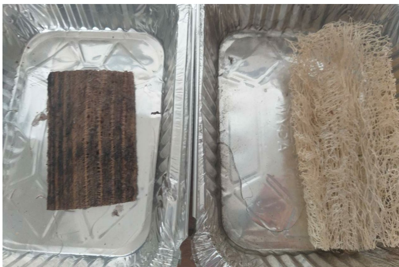
Figura 11: Amostras do thinner com a fibra de coco e fibra de bucha vegetal.
